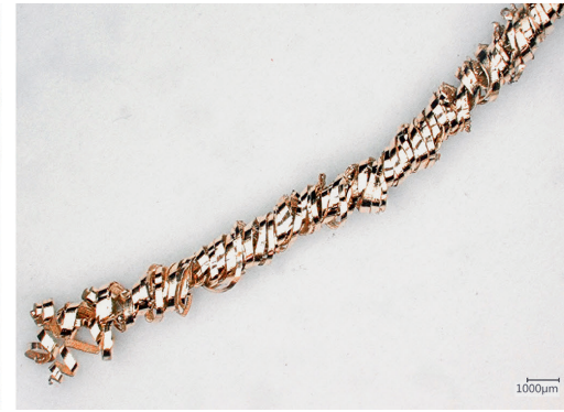
2 Beim Bearbeiten von bleihaltigem Messing entstehen kurze Späne (links), bei bleifreien Kupferlegierungen lange, schwer kontrollierbare Späne (rechts) © Bass
